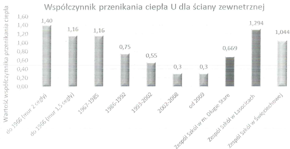
Rysunek nr 24. Współczynnik przenikania ciepła U dla ściany zewnętrznej Źródło: Opracowanie własne
